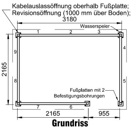
Auf Wunsch kann bei Bestellung kostenneutral eine Fußstützenverlängerung um 130 mm, für Überpflasterungshöhe bis 200 mm vorgenommen werden.
