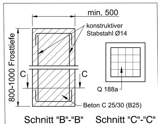
**Schnitt "B"-"B" Schnitt "C"-"C"**
