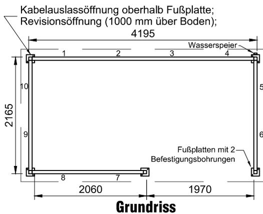
Auf Wunsch kann bei Bestellung kostenneutral eine Fußstützenverlängerung um 130 mm, für Überpflasterungshöhe bis 200 mm vorgenommen werden.
